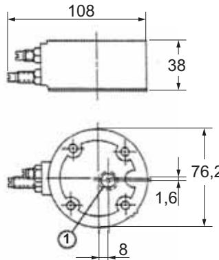
O retardo de ligamento/desligamento retarda o "tempo de ativação" (abandono da posição inicial segura) das válvulas de assento ROSS, mediante uma limitação da vazão mecânica e o membro de pressão diferencial. O adaptador é um componente opcional entre uma válvula de assento ROSS e um controle preferencial.
