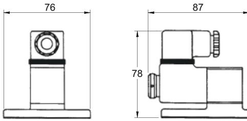
A válvula de controle prévio magnética "ALF" é uma válvula de controle prévio eletromagnética, que é aplicada em diferentes versões de válvulas de assento.
