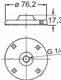
La commande pneumatique est composée d'un couvercle pour la vanne avec un filetage de raccordement libre pour le raccordement d'air de commande.
