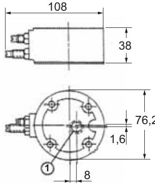
接通/断开延迟装置通过机械式流量限制器和压差元件，延长 ROSS 座阀的“接通时间”（离开确定的初始位置）。适配器是 ROSS 座阀和任意一个控制装置之间的最佳模块。
