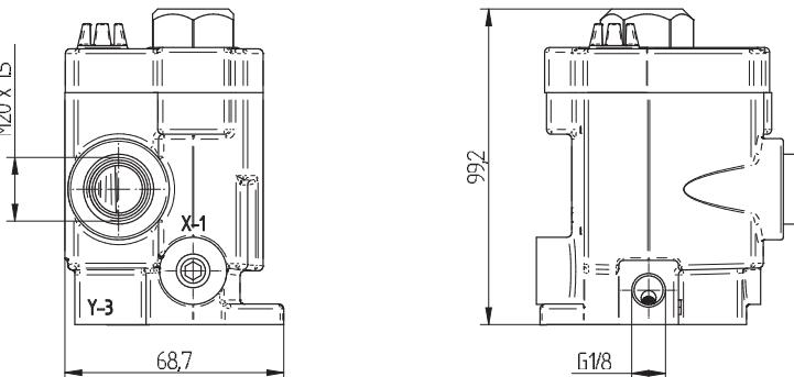
La válvula piloto magnética "PACER" es la válvula piloto electromagnética más frecuentemente usada para válvulas de asiento ROSS.
