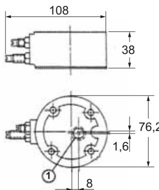
La temporisation d'activation/de désactivation retarde le « délai d'activation » [départ de la position d'origine sûre] des vannes à siège ROSS à l'aide de la limitation mécanique de débit et de l'organe de différence de pression. L'adaptateur est un module facultatif entre la vanne à siège ROSS et une commande au choix.
