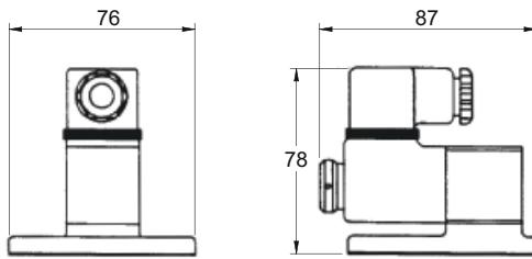
Das Magnet-Vorsteuerventil „ALF“ ist ein elektromagnetisches Vorsteuerventil, welches in verschiedenen Ausführungen auf ROSS-Sitzventilen angewendet wird.
