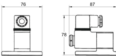
La válvula piloto magnética "ALF" es una válvula piloto electromagnética que se utiliza en diferentes versiones sobre las válvulas de asiento ROSS.
