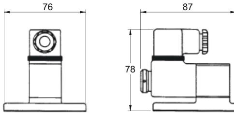
Электромагнитный управляющий клапан «ALF» может быть использован в различных исполнениях на седельных клапанах ROSS.
