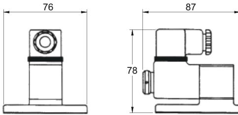
L'électrovanne pilote « ALF » est une vanne pilote électromagnétique utilisée sur les vannes à siège ROSS dans différents modèles.
