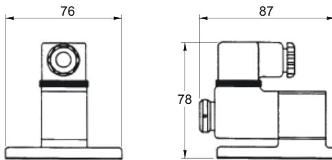
La valvola pilota magnetica "ALF" è una valvola pilota elettromagnetica che viene impiegata sulle valvole ROSS in diverse versioni.
