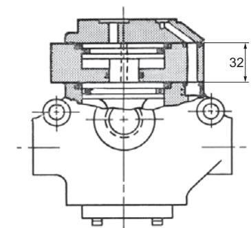
アダプター「PB」は、運転に必要な力を高めるための補助ピストンです。
