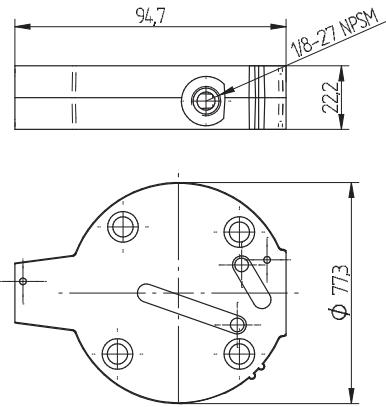
O adaptador "EEZ-ON" consegue um aumento controlado da pressão nos sistemas pneumáticos.
