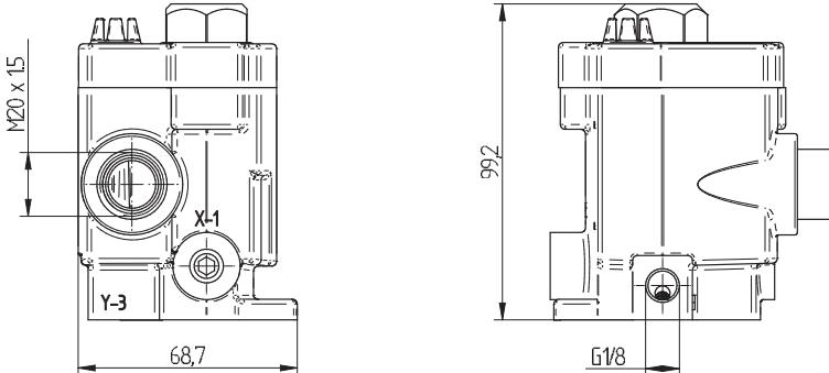
L'électrovanne pilote « PACER » est la plus fréquemment utilisée avec les vannes à siège ROSS.
