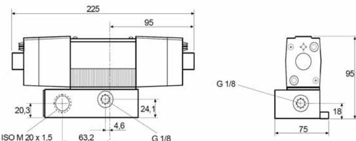
La válvula piloto con doble imán "CV1" permite un control por medio de impulsos eléctricos.
