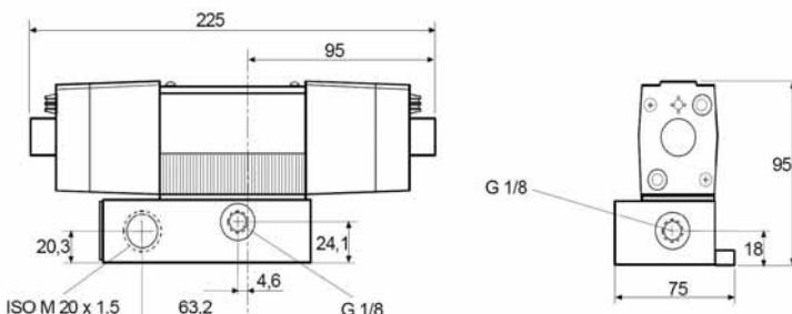
La valvola pilota a doppio magnete "CV1" permette il comando mediante impulsi elettrici.
