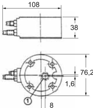
El retardo de conexión/desconexión retraza el "tiempo de conexión" de la válvula de asiento ROSS [al salir de la posición inicial segura] mediante una limitación mecánica de caudal y un elemento de presión diferencial. El adaptador es un módulo opcional que se coloca entre una válvula de asiento ROSS y una excitación cualquiera.
