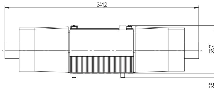
A válvula de controle prévio de magnete duplo "CV1" possibilita um controle por meio de impulsos elétricos.
