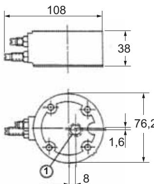
Die Ein-/Ausschaltverzögerung verzögert die „Einschaltzeit“ (Verlassen der sicheren Grundstellung) der ROSS-Sitzventile mittels mechanischer Durchflussbegrenzung und Druckdifferenzglied. Der Adapter ist optionaler Baustein zwischen einem ROSS-Sitzventil und einer beliebigen Ansteuerung.
