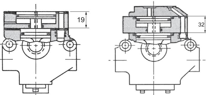
L'adaptateur « PB » est utilisé comme piston auxiliaire pour l'augmentation de la force d'actionnement.
