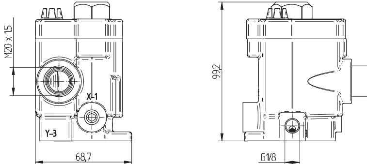
Электромагнитный управляющий клапан «PACER» – это широко использующийся электромагнитный управляющий клапан для седельных клапанов ROSS.
