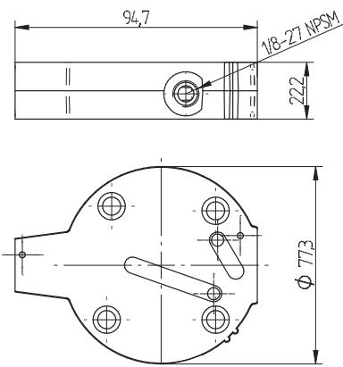
L'adattatore "EEZ-ON" realizza un aumento controllato della pressione nei sistemi pneumatici.
