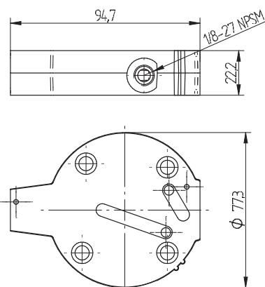
L'adaptateur « EEZ-ON » assure une formation contrôlée de la pression dans les systèmes pneumatiques.
