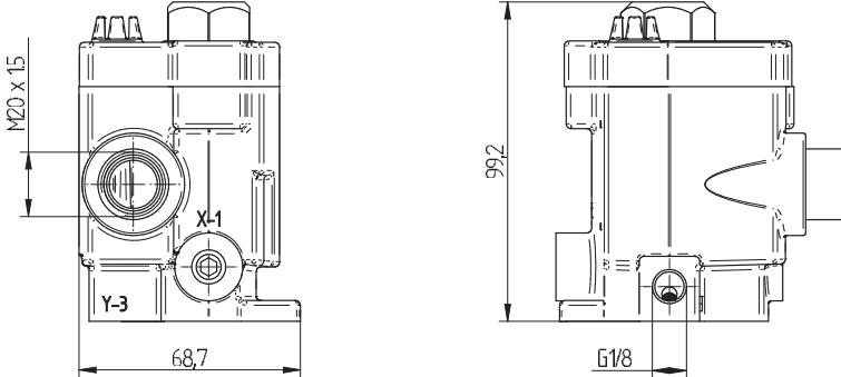
A válvula de controle prévio magnética "PACER" é a válvula de controle prévio eletromagnética mais utilizada para válvulas de assento ROSS.
