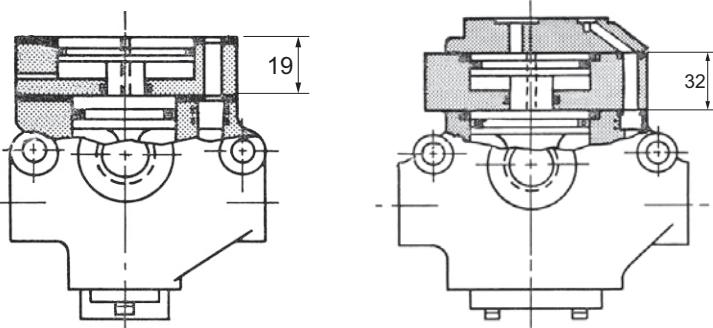
O adaptador "PB" é utilizado como êmbolo auxiliar para aumento da força de ativação.
