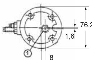
オン／オフ遅延は、機械的フロー制限と圧力差パーツによりROSS製ポペットバルブの「オン時間」（安全な基本位置からの退出）を遅延させます。アダプターは、ROSS製ポペットバルブと任意の制御間で使用する。オプションのパーツです。
