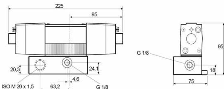
Управляющий клапан с двойным магнитом «CV1» позволяет осуществлять управление с помощью электрических импульсов.
