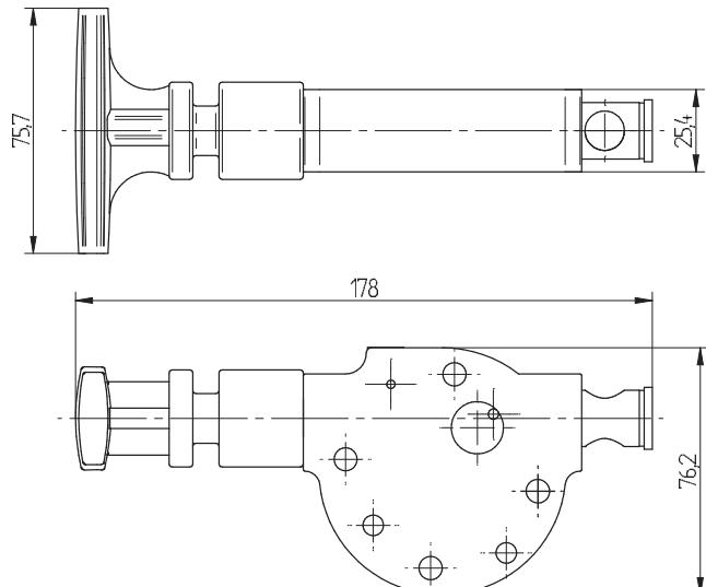
El adaptador "LOX" garantiza una desconexión neumática de la energía según la norma EN1037.
