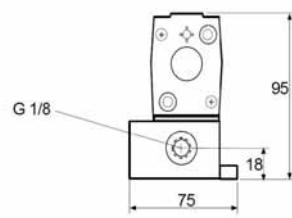
ダブルマグネット式パイロット弁「CV1」により、電気インパルスを介した制御が可能になります。
