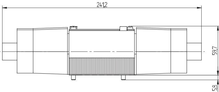
双磁体先导阀“CV1”可通过电脉冲进行控制。
