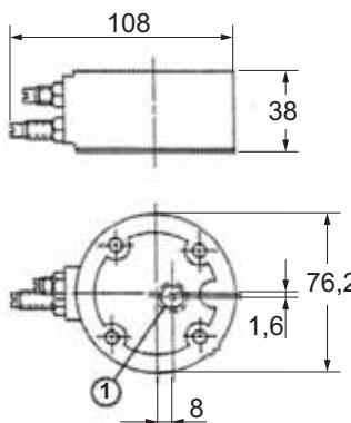
Задержка включения/выключения увеличивает «время включения» (выход из безопасного основного положения) седельных клапанов ROSS путём механического ограничения расхода и использования элемента перепада давления. Адаптер является опциональным модулем между седельным клапаном ROSS и любым устройством управления.
