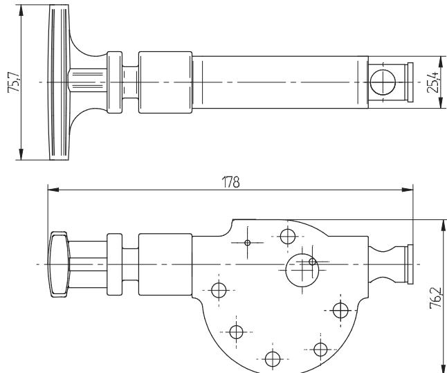
Адаптер «LOX» обеспечивает пневматическое разделение энергии согласно EN1037.
