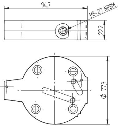
Адаптер «EEZ-ON» обеспечивает контролируемый обрыв давления в пневматических системах.
