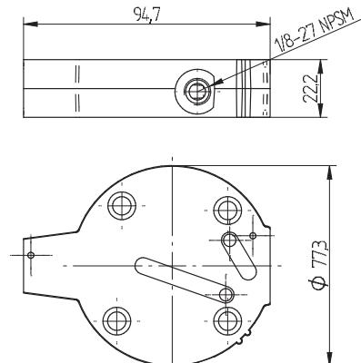
适配器“EEZ-ON”能让气动系统中的压力增长可控。
