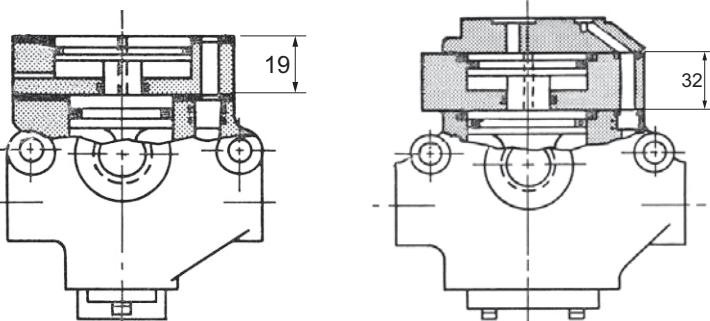
El adaptador "PB" se utiliza como émbolo auxiliar para aumentar la fuerza de accionamiento.
