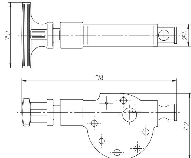
Der Adapter „LOX“ gewährleistet eine pneumatische Energietrennung nach EN1037.
