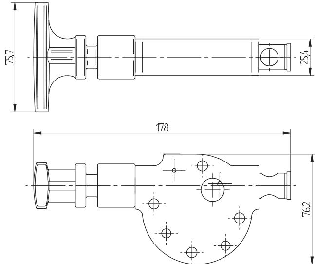
O adaptador "LOX" garante um isolamento de energia pneumática, conforme a EN1037.
