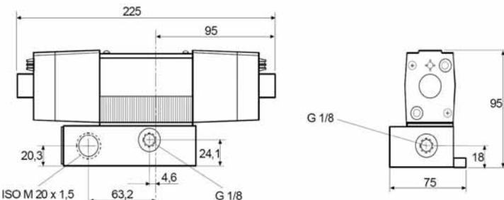
L'électrovanne à double aimant « CV1 » permet une commande par impulsions électriques.
