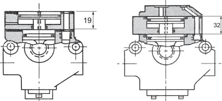
Der Adapter „PB“ wird als Hilfskolben zur Erhöhung der Betätigungs Kraft verwendet.
