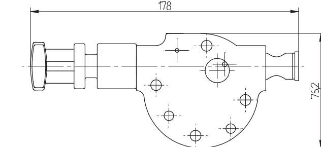
アダプター「LOX」は、EN1037に即して空気駆動エネルギーを分離します。
