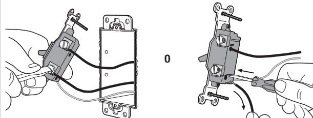
**Terminales de tornillos:** Para soltar los tornillos dele vueltas hacia la izquierda.
