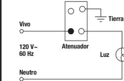
**Nota:** Si esta reemplazando un interruptor unipolar con tres vías o unipolar/de atenuador tres vías, el tornillo en el mismo lado del tornillo de color diferente no se usa. Apriete y asegúrelo.
